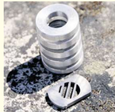
Der Grad der Zerkleinerung der Trockeneispellets lässt sich je nach Ausrichtung der vier Lochplatten im Scrambler auswählen, ein wichtiges Zubehör besonders im Einsatz auf heiklen Oberflächen.
