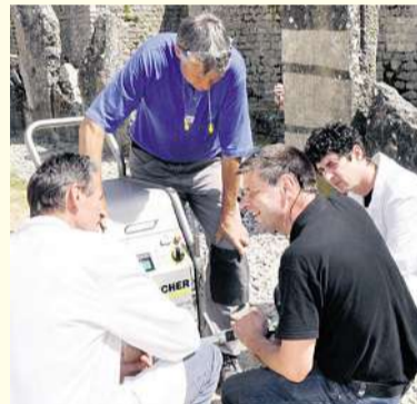
Die Mitarbeiter des Restaurations-Teams lassen sich das Trockeneisstrahlgerät Ice Blaster IB 7/40 von Marcel Hodel, Servicetechniker bei Kärcher, erklären.
